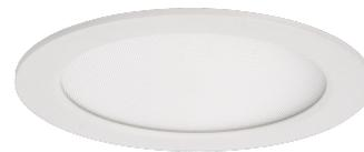
Luminaire encastré DOWN LIGHT rond, fixe. Équipé de technologie LED. Colerette en fonte d'aluminium de diamètre 230mm. Fixation dans les plafonds suspendus à l'aide de deux ressorts. Alimentation déportée. Les luminaires communiquent sans fil (ZIGBEE 3.0 PHILIPS) avec la commande murale (BP) sans piles GREEN POWER (à commander séparément). Programmation via application PHILIPS.
