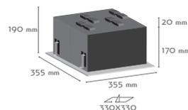
Luminaire encastré DOWN LIGHT multidirectionnel à 30° verticalement. Reçoit des lampes à Iodure Métalliques à culot G12. Corps en acier laqué gris argent par poudrage. Protection des lampes par un verre trempé avec un motif décoratif. Alimentation précâblée intégrée dans un boîtier déporté.
